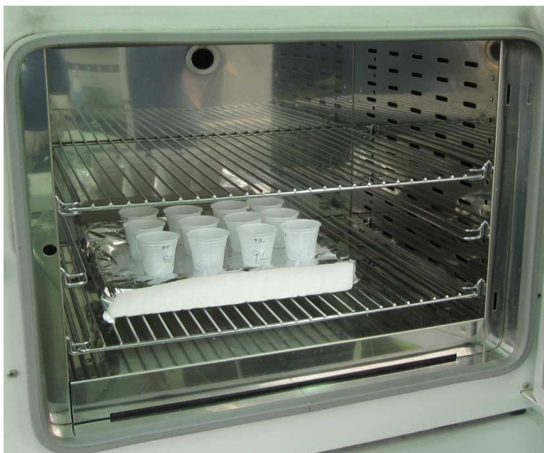
FIGURA 11: CAMPIONI POSTI IN STUFA A 60°C
